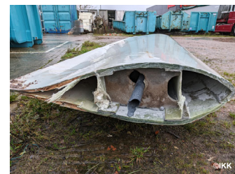
Die Struktur eines Rotorblattes weist eine Vielzahl von Materialien auf
