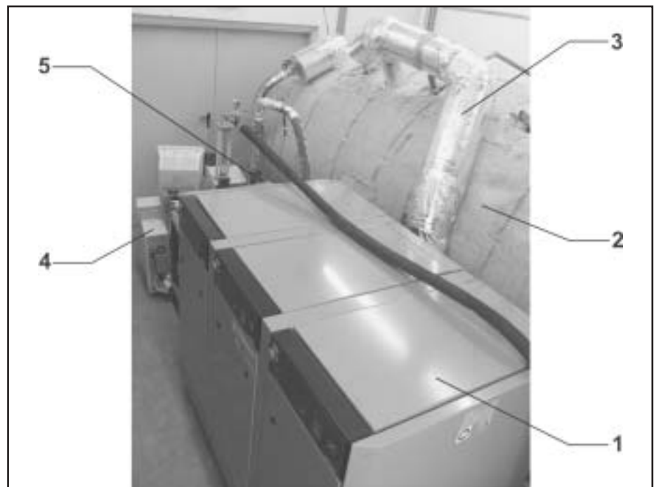
Bild 4: Versuchsanlage für Systemuntersuchungen bei Verwendung warmer Druckluft 1 - Verdichtereinheit aus drei parallel-geschalteten ölfreien Hubkolbenkompressoren ohne Nachkühlung; Verdichtungsendtemperatur ca. 190°C, max. Enddruck 10 bar(ü), 2 - Kessel (8 m³) für warme Druckluft, isoliert mit 16 cm dicken Mineralwolle (folienkaschiert), 3 - Druckleitung vom Verdichter zum Kessel, isoliert mit 16 cm Mineralwolle (folienkaschiert), 4 - Prüfstand für Motortests, 5 - Rechner zur Messwerterfassung
